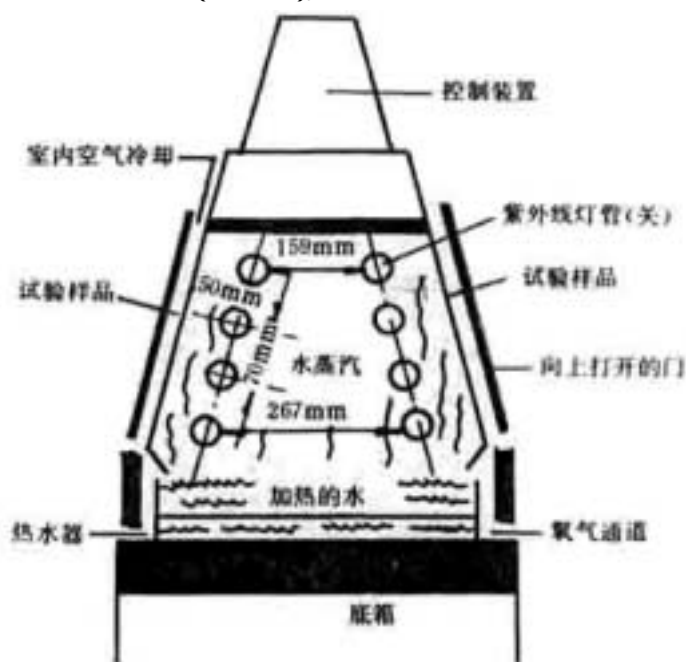
图 1 荧光紫外线/冷凝试验箱结构截面图
